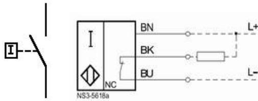
El **Detector Inductivo** es un fin de carrera que trabaja exento de roces y sin contactos, no está expuesto a desgastes mecánicos y en general es resistente a los efectos del clima. Su empleo es especialmente indicado allí donde se requieren elevadas exigencias, precisión en el punto de conexión, duración, frecuencia de maniobras, y velocidad de accionamiento
