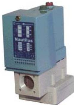
El presostato es un mecanismo que abre o cierra unos contactos que posee, en función de la presión que detecta. Esta presión puede ser provocada por aire, aceite o agua, dependiendo del tipo de presostato. Se suelen usar en grupos de presión de agua, poniendo en marcha un motor-bomba cuando la presión de la red no es suficiente.
