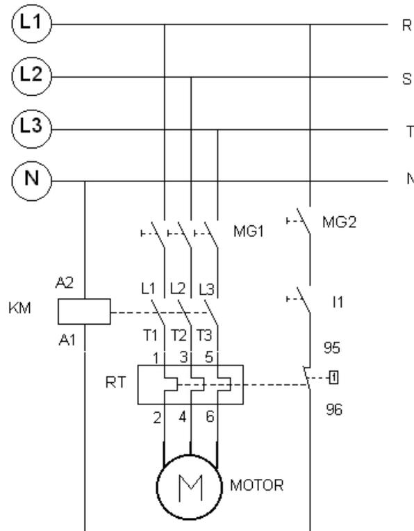
Uniendo en un solo esquema el **circuito de fuerza** y el de **maniobras**, obtenemos el **circuito de conexiones**. En él podemos ver con claridad como se conectan todos los elementos de la instalación.
