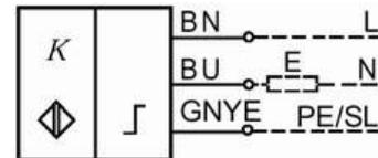
Estos **detectores** de proximidad **capacitivos** son interruptores de límite, que trabajan sin roces ni contactos. **Pueden detectar materiales de conducción o no conducción eléctrica**, que se encuentran en estado sólido, líquido o pulvarento, entre otros: vidrio, cerámica, plástico, madera, aceite, agua, cartón y papel. El DETECTOR se conecta cuando él y el material se encuentran uno enfrente del otro a una determinada distancia.
