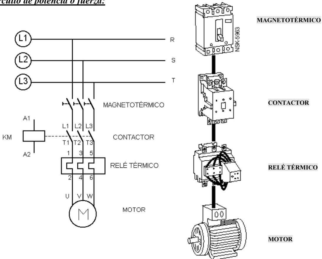
L1, L2 y L3 corresponden con las tres fases R, S y T de la corriente alterna trifásica que alimenta el circuito.
