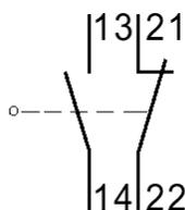
Como se puede observar, el final de carrera está compuesto por un contacto normalmente cerrado y otro normalmente abierto. Cuando se presiona sobre el vástago, cambian los contactos de posición, cerrándose el abierto y viceversa.
