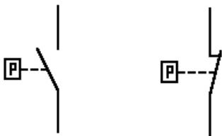
Los contactos pueden ser normalmente abiertos o normalmente cerrados, dependiendo del tipo de presostato.
