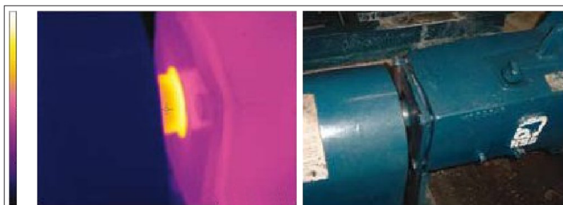
FIGURA 1.5. Exemple d'escalfament de l'eix del motor vist per càmera termogràfica
