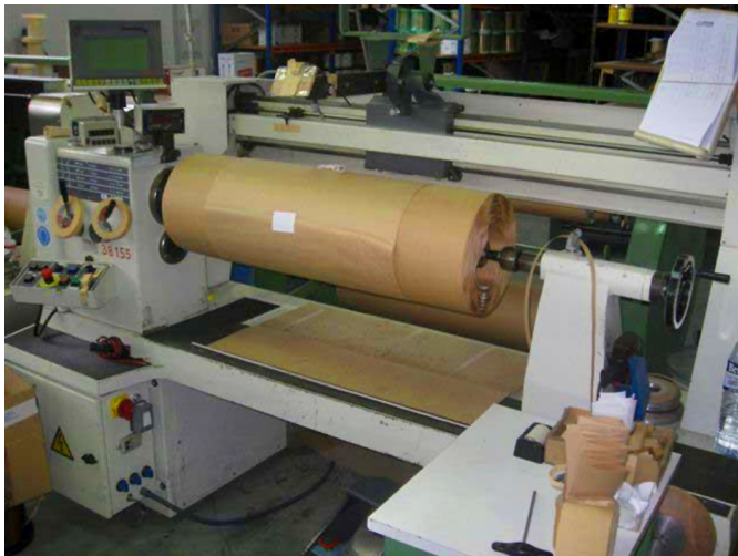
FIGURA 1.17. Aïllant entre capes per a un transformador
