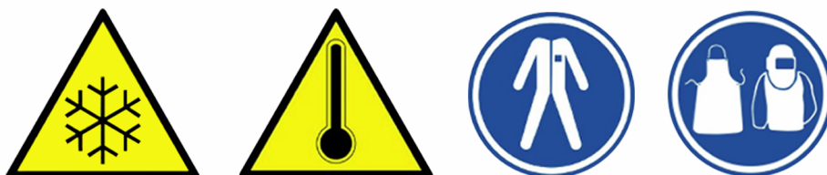
FIGURA 1.8. Els senyals que estan per ordre: perill de molta baixa temperatura, perill de molt alta temperatura, utilització d'indumentària especial i ús de protecció per altes temperatures.
