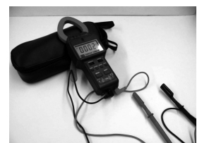
El wattímetre és l'aparell que mesura la potència activa monofàstica en corrent altern.
