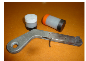
Diferents elements per realitzar la soldadura aluminotèrmica.
