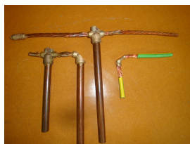
Soldadura aluminotèrmica. Exemples de conductors units amb aquest tipus de soldadura que també s'utilitza per unir les vies del tren.
