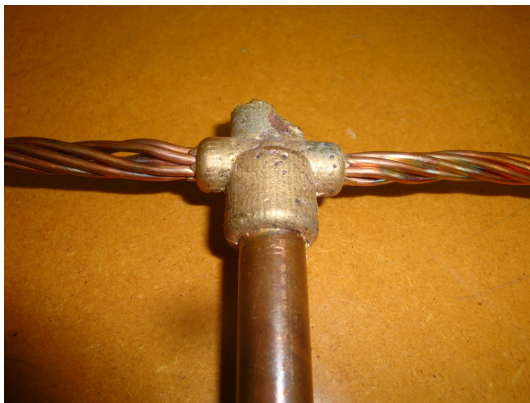
FIGURA 1.21. Exemple de soldadura aluminotèrmica.
