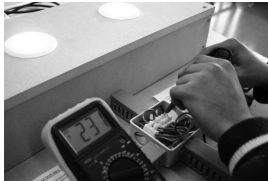
Exemple de mesura de tensió d'una instal·lació elèctrica que realitza un instal·lador autoritzat.
