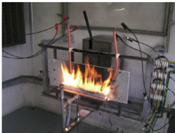
FIGURA 2.6. Prova de resistència al foc d'un cable
