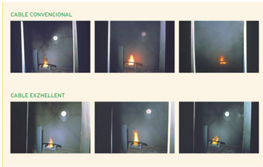
FIGURA 2.9. Assaig d'opacitat de fums
