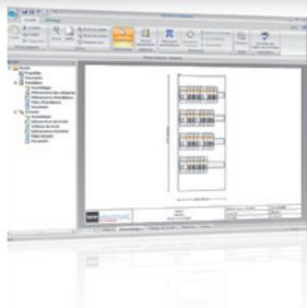
Con el fin de suministrar un proyecto completo al cliente final, el módulo « Armario » permite crear rápidamente una vista realista y dimensionada de los cuadros eléctricos y de los accesorios correspondientes.
