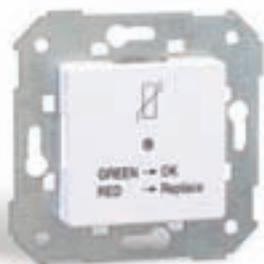
El protector contra sobre tensiones de empotrar, permite proteger los aparatos conectados a las tomas de corriente, con toma de tierra que estén conectadas a él contra los efectos de sobre tensiones tanto de origen atmosférico como de conmutación.
