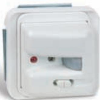
Estos detectores facilitan la conexión de cargas a través de la captación de calor móvil y mantienen esta conexión durante un tiempo ajustable entre 4 segundos y 10 minutos, rearmables por un movimiento de la fuente de calor, pero a diferencia de los demás detectores estos también rearmen la temporización mediante cualquier sonido que se produzca en su entorno.
