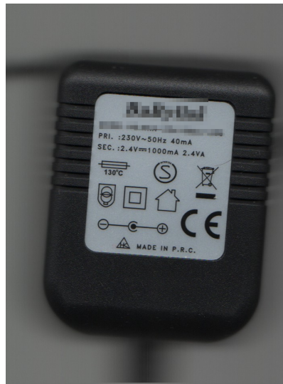
FIGURA 1.2. Font d'alimentació interior 230 V - 2,4 V
