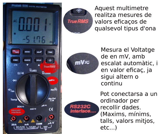
FIGURA 2.3. Detalls de multímetre de gamma alta
