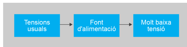
FIGURA 1.6. Diagrama d'instal·lacions a molt baixa tensió
