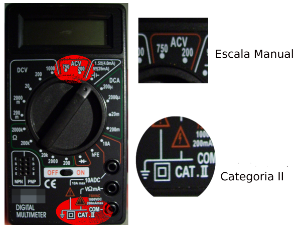
FIGURA 2.1. Detalls de multímetre de gamma baixa
