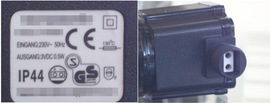
FIGURA 1.5. Font d'alimentació MBTS exterior amb els símbols que la identifiquen.
