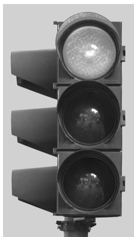
Un semàfor és un exemple típic de sistema seqüencial.
