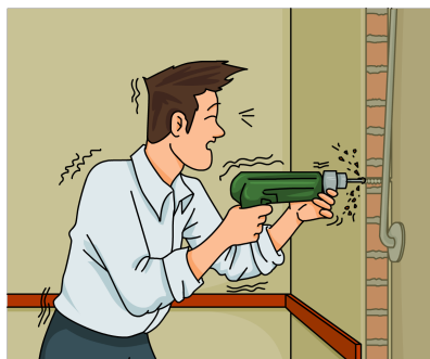
FIGURA 3.12. Canalitzacions elèctriques encastades
