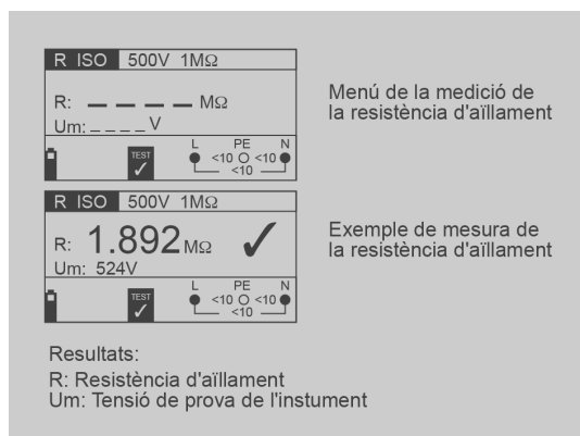
FIGURA 3.24. Resultats de la mesura de la resistència d'aïllament amb un mesurador multifunció Metrel KMI 3102
